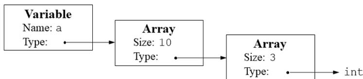
图2. 多维数组的链表表示示例。
